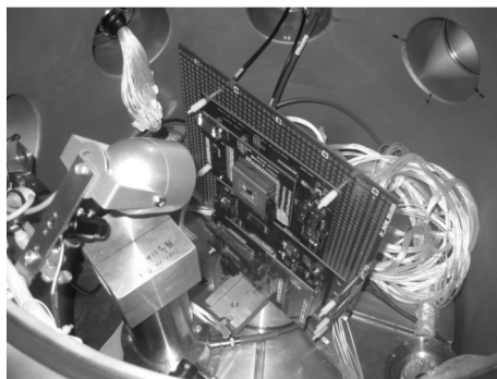
图 4 单粒子效应试验电路板(HIRFL 加速器试验)
